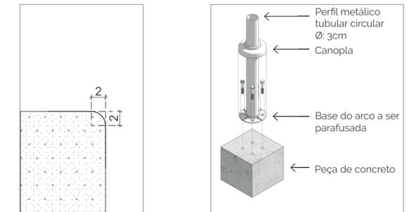
detalhe 1 bordas das peças de concreto escala gráfica 0 10cm
