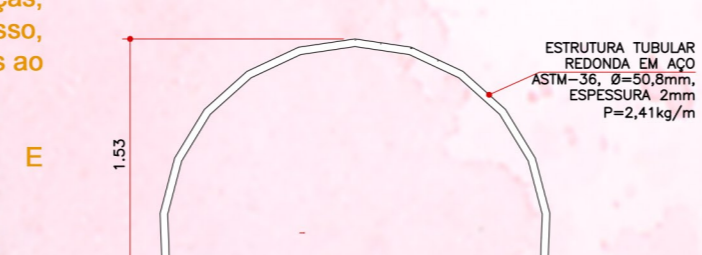
Vista Frontal - Escada em Arco ESC.: 1:50
