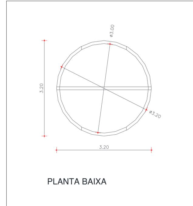
O EQUIPAMENTO URBANO É CONSTITUÍDO BASICAMENTE DE QUATRO MATERIAIS: FERRO - EVA - CABOS TENCIONADOS - FOLHAS DE ARVORES. O PROJETO TEM INÍCIO COM A MONTAGEM DA ESTRUTURA EM FERRO CIRCULAR OCO COM DIÂMETROS DE .5 CM E .10 CM INCLUI SOLDA DUPLA, APLICAÇÃO DE PRIMER ADERENTE E TINTA A BASE DE EPÓXI. TODA ESTRUTURA METÁLICA DEVERÁ SER REVESTIDA COM MANTA DE E.V.A. DE ESPESSURA DE 1 CM. NO PISO A SER INSTALADA ESSA ESTRUTURA VAI SER CRIADA UMA BASE EM CONCRETO.
