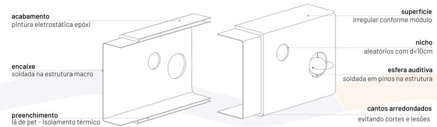
As peças em alumínio permitem uma estrutura leve e ao mesmo tempo resistente que suporta a capacidade de carga acidental que será aplicada. Suas juntas soldadas unem de forma segura as chapas que compoem o mobiliário. Este possui duas camadas, para isolamento térmico, agregado de lã de pet para uma maior eficiência.
