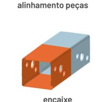
O encaixe das peças busca a simplicidade e praticidade nos processos de fabricação e de montagem. Com encaixes macho e fêmea, cada módulo pode ter suas extremidades projetadas conforme a necessidade de layout. Com um encaixe na forma de negativo, o contato entre as peças se alinha sem deixar desníveis, evitando assim eventuais lesões dos pequenos usuários.
